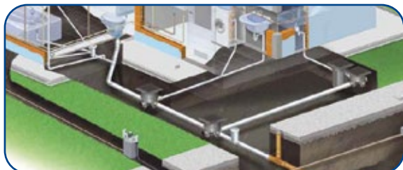
Línea Desagüe y Junta Elástica
